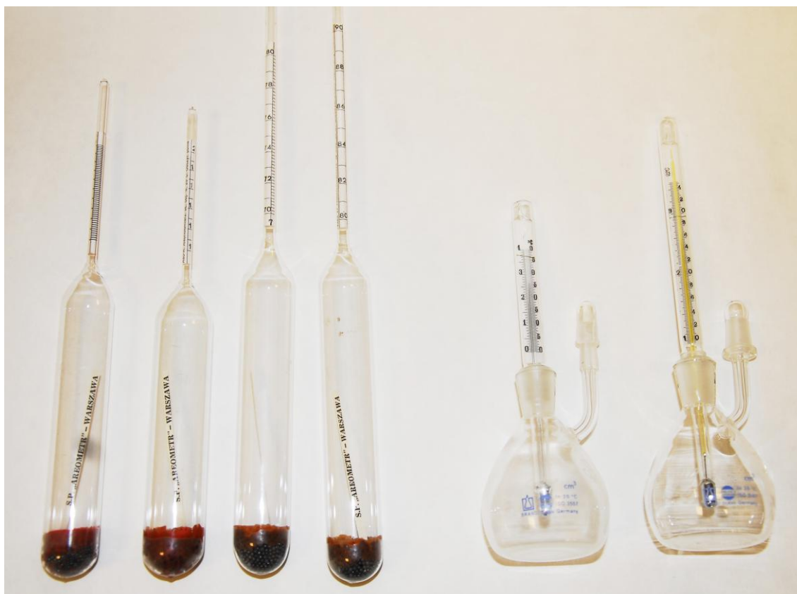
Zdj. 3.1. Różne rodzaje areometrów (a) i piknometrów (b).
