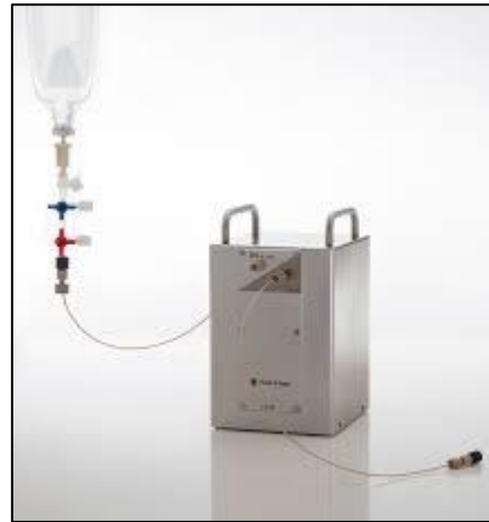
Generator germanowo-galowy ( ^{68}\text{Ge}/^{68}\text{Ga} )
